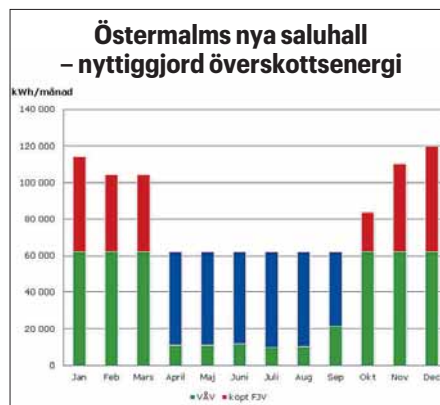
Figur 2: Under uppvärmningssäsong ersätter den återvunna kondensorvärmnet köpt fjärrvärme. Övrig tid bereds tappvarmvatten och överskottsenergin kyls bort med gaskylare och fjärrkyla.
